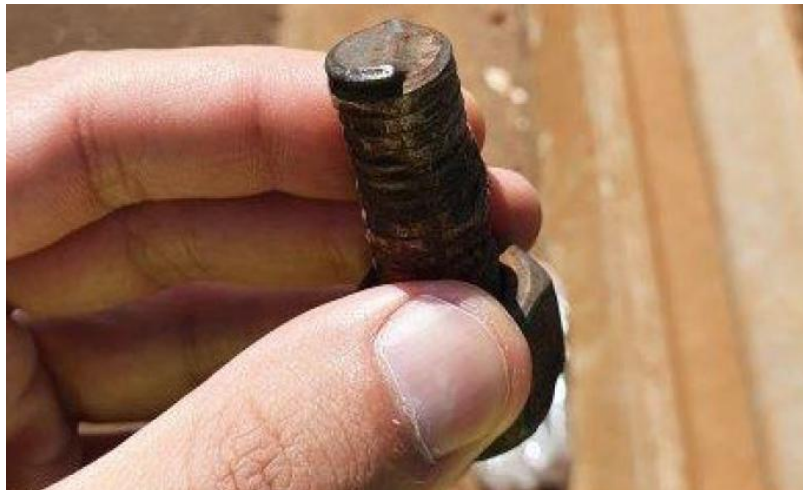
Ilustración 6 - Zona de falla de tornillo de sujeción
