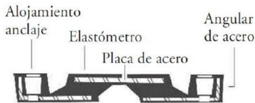
Figura 6 – Corte general de la junta Transflex
