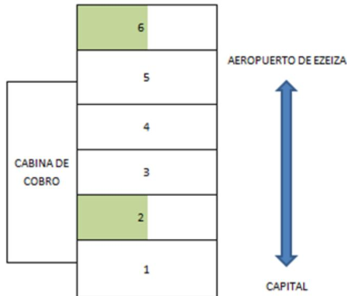
El trabajo consistirá en la demolición y reconstrucción parcial y/o total de las losas de hormigón existentes que se encuentren fisuradas o fracturadas. Se utilizará Hormigón calidad H-38 FastTrack, previa aprobación de la fórmula de mezcla que se presentará ante la Jefatura de Fiscalización. El espesor mínimo del pavimento deberá ser de 24 cm, pero se deberá respetar el espesor existente de las losas contiguas.
